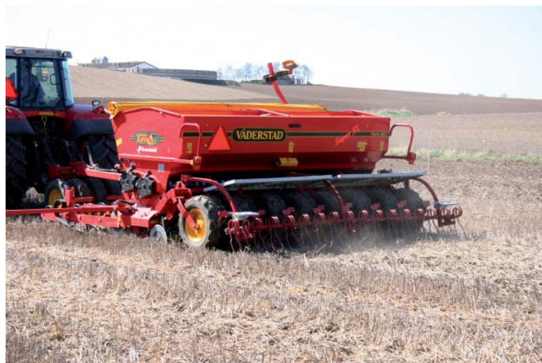
Direkte såning i stubben med en Väderstad Rapid. Foto: Janne Aalborg Nielsen, Landscentret, Planteproduktion.
